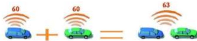
Figure 1 - Addition de deux sources de bruit de même intensité (Source : www.bruitparif.fr )
